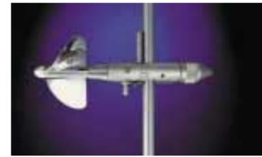
bei extremen Ereignissen (Hoch- und Niedrigwasser), über die sogenannte Abflussmessung mit dem hydrometrischen Flügel im Gewässer stehend, bestimmt. Gemessen wird die Umdrehungszahl des Flügels an verschiedenen Punkten des definierten Querschnitts – sie ist ein Maß für die mittlere Fließgeschwindigkeit. Der Abfluss ist das Produkt aus mittlerer Fließgeschwindigkeit und Querschnittsfläche.
