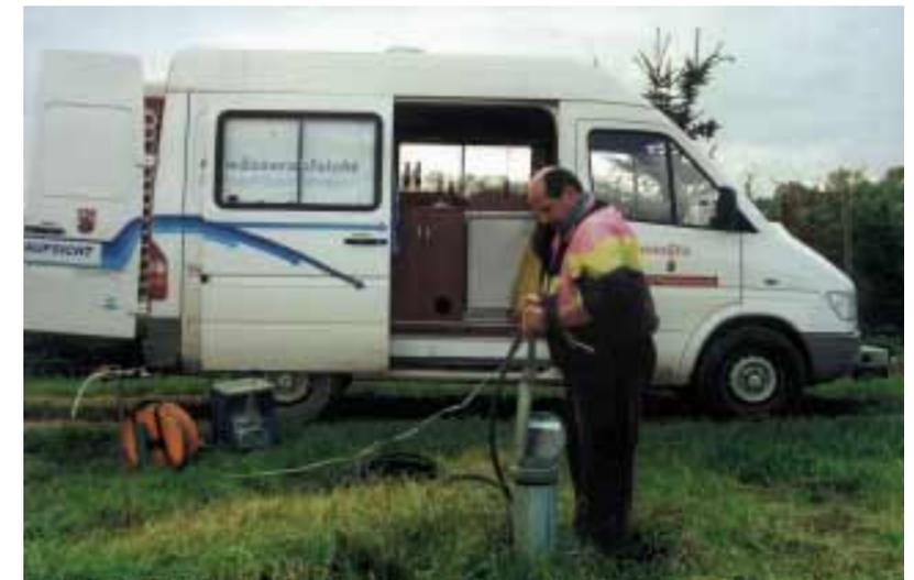
Mit der Tauchmotorpumpe wird Grundwasser aus einem Beobachtungsrohr zur Analyse entnommen
