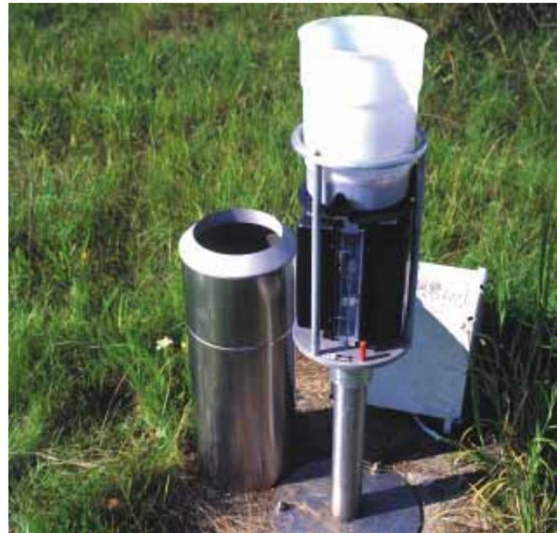
Ombrometer liefern fortlaufende Aufzeichnungen über Niederschlagshöhe und -dauer und damit exakte Daten über die Niederschlagsintensität.
